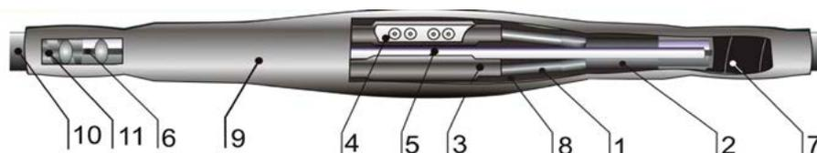
1 – Трубка изолирующая; 2 – Перчатка изолирующая; 3 – Манжета изолирующая; 4 – Соединитель болтовой, под опрессовку или пайку; 5 – Трубка ХВТ; 6 – Провод заземления; 7 – Лента герметик; 8 – Межфазный наполнитель; 9 – Труба наружная; 10 – Кабель; 11 – Бронеленты.
