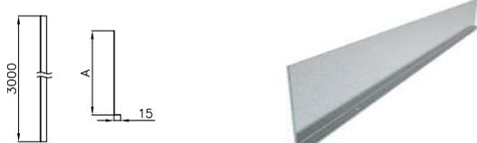
Применяется для разделения кабелей и линий с различным напряжением и функциями. Комплектуется четырьмя заклепками АЛ/СТ 4,0х12. Устанавливается на прямые секции лотков.
