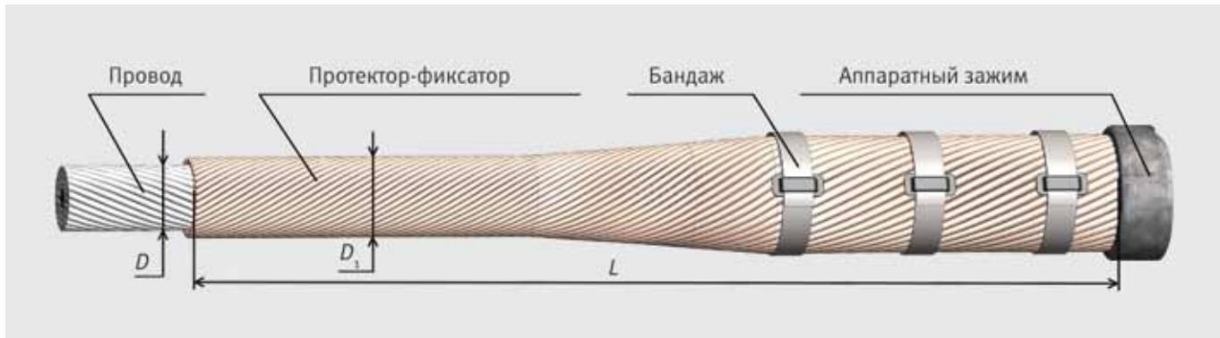
ПЗС-Дпр-43 — для защиты полых проводов типа ПА от изгибных деформаций, имеющих место при колебаниях от ветровых воздействий, в местах их выхода из аппаратных зажимов. Комплектуется монтажной нержавеющей лентой (120 см) и замками-фиксаторами (3 шт.).
