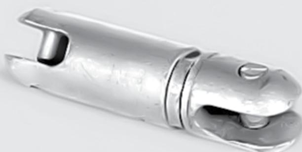
Вертлюги монтажные типа В (ТУ 5221-060-27560230-99 и ТУ 5221-27560230-13) предназначены для предотвращения закручивания самонесущих оптических кабелей связи при монтаже под тяжением. Вертлюг устанавливается между лидер-тросом и кабелем и используется в сочетании с монтажным чулком.
