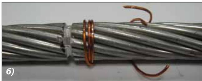
**8** Выплести одну из проволок, выкусывая ее длину частями длиной около 70 см (рисунок "а") болторезом (кусачками боковыми рычажными).
