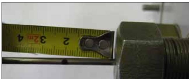
**2** Удалить трубку ОМ до нанесенной метки на ОМ отрезками длиной около 70 см, применяя приспособление РММ для резки металлического модуля с ОВ (рисунки "а" и "б"), в соответствии с руководством по эксплуатации РММ (ГК-У350.00.000 Д).
