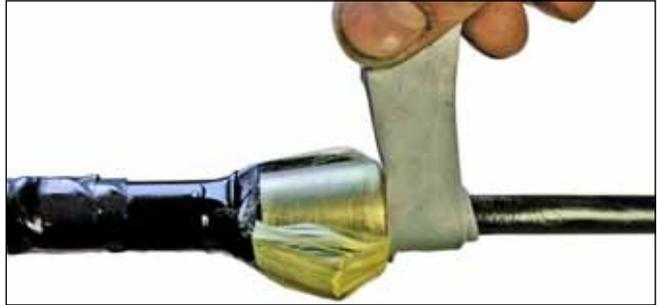
**7.5** Надвинуть гайку внутреннюю на арамидные нити, надвинуть на ОК штуцер и продвинуть его к гайке.
