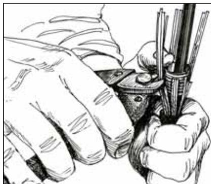
**6.3** Разрезать пластину ленты Scotch 2900R или ее аналога (далее лента 2900R) вдоль на две части и поочередно намотать ее на внутреннюю оболочку ОК возле конуса, заводя витки ленты под конус.
