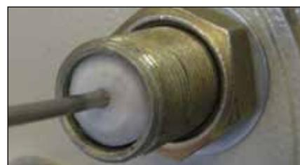
**25** Установить втулку металлическую до упора во втулку уплотнительную.
