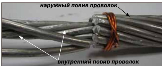
**10** Надпилить проволоки внутреннего повива многофункциональным инструментом Dremel с отрезным диском  $\varnothing$  38 мм (или ножовкой).
