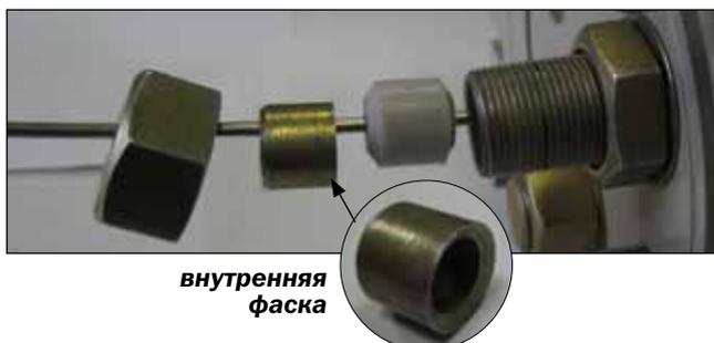
**24** Установить втулку уплотнительную внутрь штуцера до упора.
