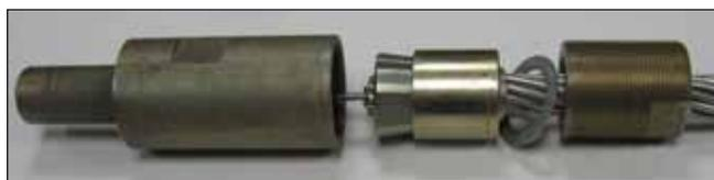
**18** Свинтить друг с другом штуцер и гайку внутреннюю, используя ключи гаечные S=32 мм и S=40 мм. Этим обеспечивается закрепление ОКГТ в кулачках ввода.
