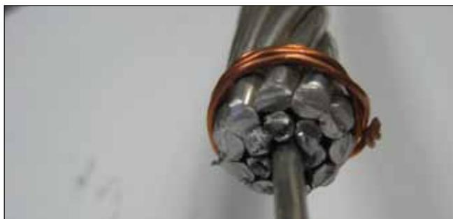
**12** Протереть поверхность ОМ салфеткой с жидкостью для удаления гидрофобного заполнения ("D-Gel"), не подвергая ОМ изгибу.
